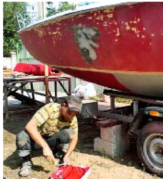
Красим борт ниже ватерлинии двухкомпонентной эпоксидной противосмосовой краской. Она наносится на рекомендованную производителем краски грунтовку
