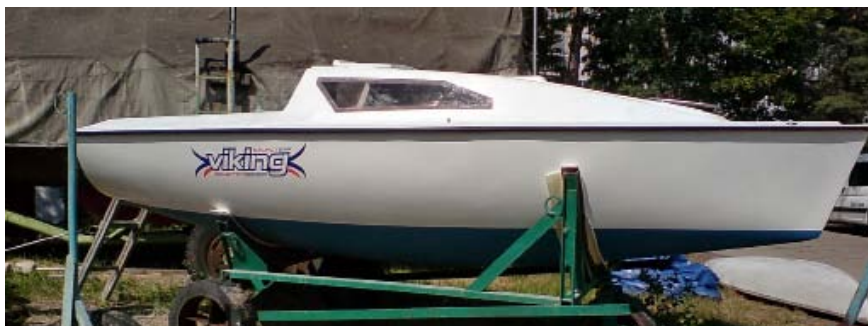
Готовая покрашенная гелькоутом, отшлифованная и отполированная яхта
