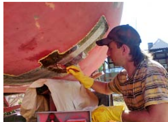
Накладываем чередующиеся слои мата и ткани: от узких в начале набора до широких — при выходе на уровень борта
