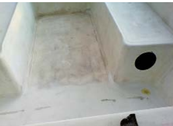
Так выглядит палуба после разделки всех критических мест
