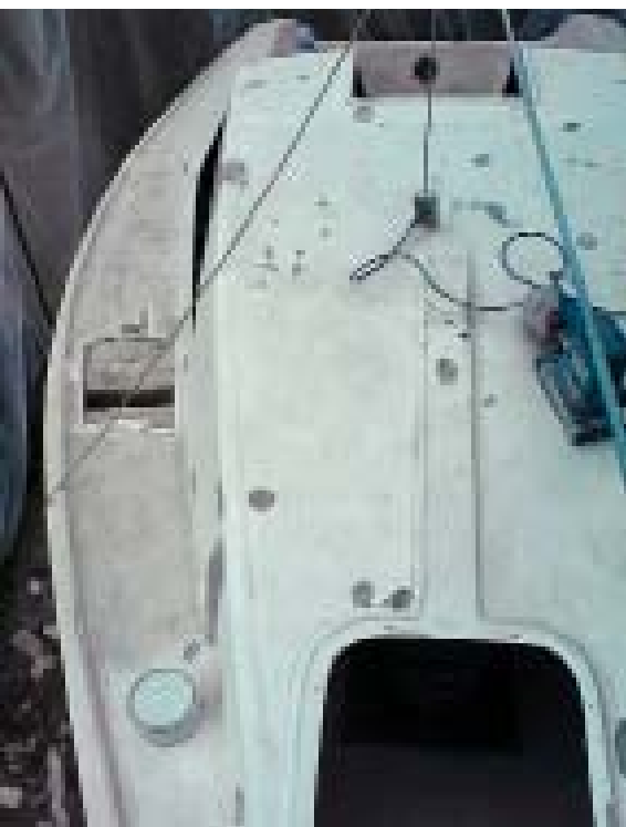
Так выглядит палуба после разделки всех критических мест
