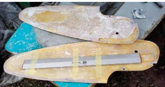
Ремонт заводского пера руля
