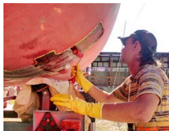
Прикатываем финишный слой мата для выравнивания
