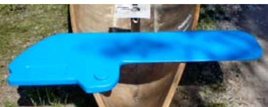
Заводской деревянный шверт отчищаем от краски, шлифуем, покрываем полиэфирной смолой, затем — необрастайкой
