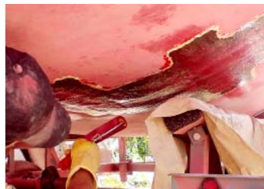
1. Начальные слои в середине разделанного углубления. 2. Финишные слои — вровень с поверхностью борта
