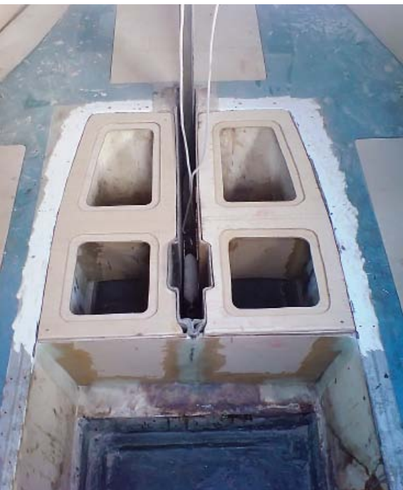
Если усиливающие переборки заформовать крышкой, то они будут нести еще и функцию рундуков
