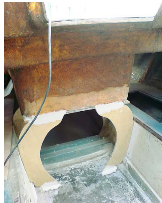
Усиление кокпита с помощью установки дополнительных опор
