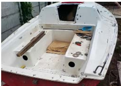
Начало ремонта: зачистка корпуса, выявление и вскрытие пузырей и расслоений
